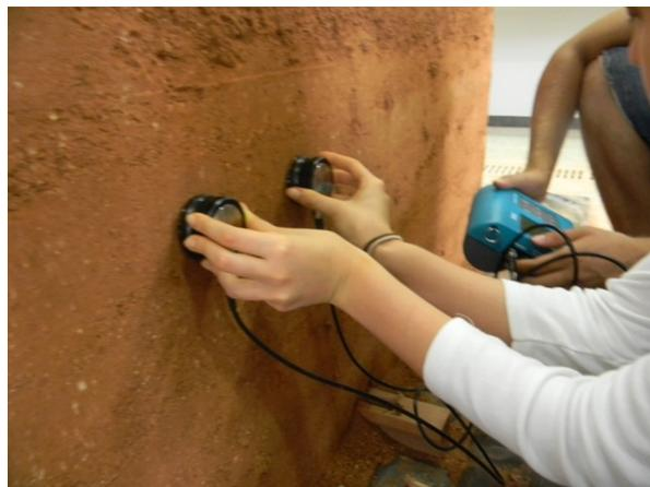
FIGURA 2: Teste de ultrasonido en el Panel 5.
